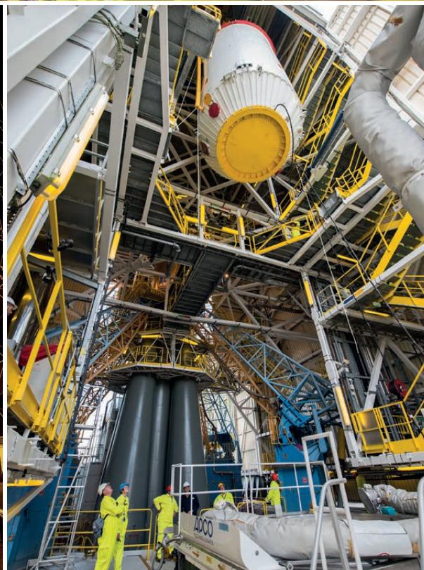
oben: Galileo-FOC*-Satelliten 9 und 10 (inkl. vier mitgezählter IOV – In Orbit Verification – Satelliten der Testphase) werden in der Sojus-Ummantelung montiert links: Galileo*-Raketenstart, rechts: Galileos* werden zur Raketenspitze gehievt
