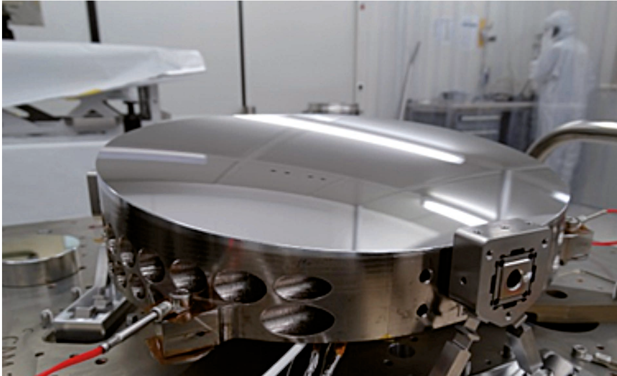
EnMAP: Fertig geklebtes Spiegel-Assembly auf der Integrationsplatte. Die Münchener Spezialisten haben eigens dafür einen Klebprozess mit speziellen Vorrichtungen entwickelt und qualifiziert.
