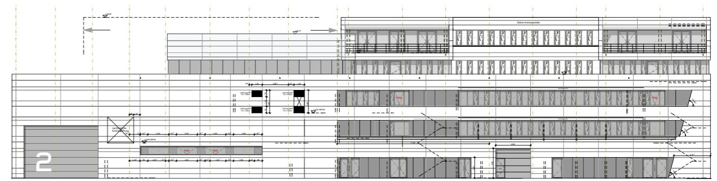
2 Gebäudeansicht von Südwesten. Durch das große Rolltor ganz links können auch sehr große Satellitencontainer ein- und ausgebracht werden.
