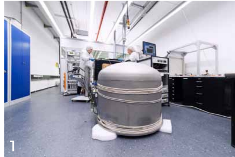
1 Thermal-/Vakuum-Labor unter ISO8-Bedingungen. Die im Weltraum herrschenden thermalen Bedingungen, denen Bauteile und Komponenten über eine bestimmte Dauer ausgesetzt werden, können in den Kammern simuliert werden.
