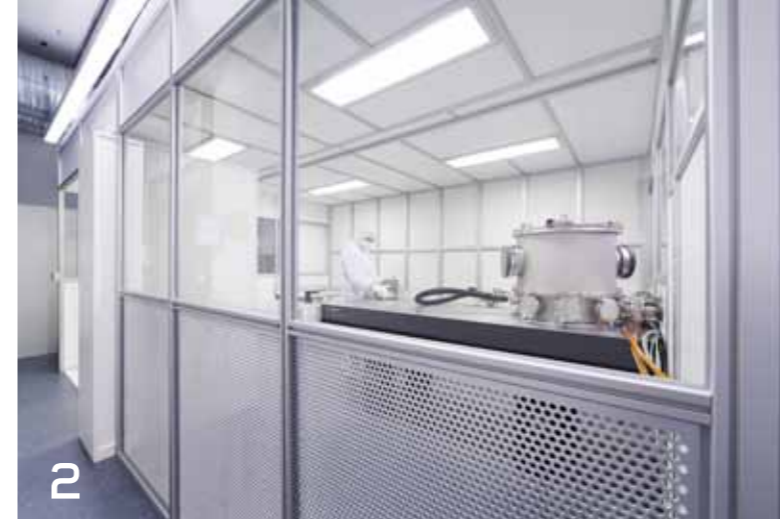
2 ISO5-Reinraum als Raum-im-Raum-System innerhalb des Thermal-/Vakuum-Labors.
